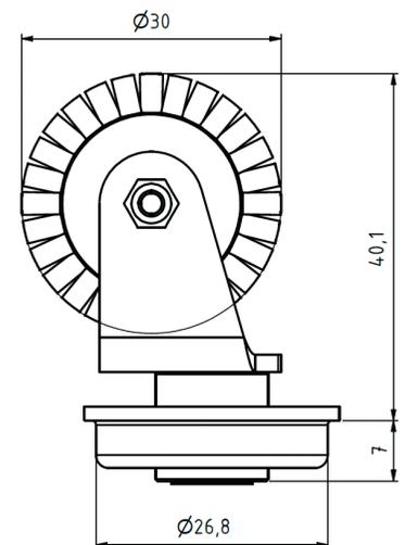
Bestehend aus einem Kugellager und einer vormontierten Mink Transportbürstenrolle
