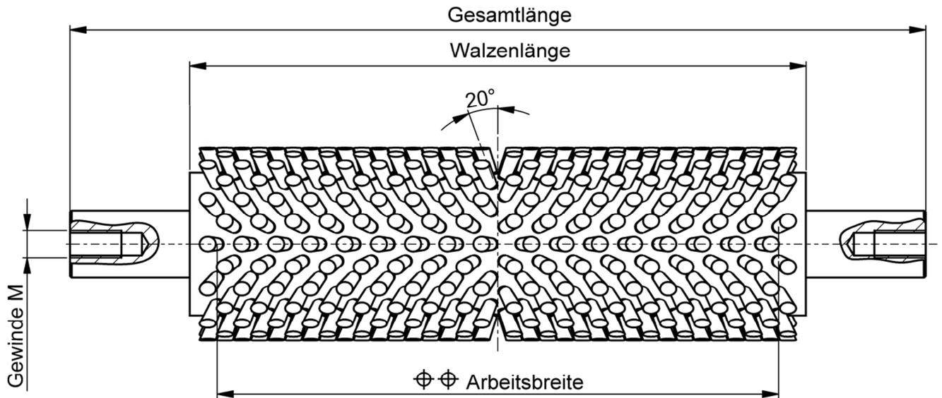
Die **Mink Breitstreckwalze BSW-PP42** hat einen Gesamtdurchmesser von 57 mm. Die durchgehende, kugelgelagerte Edelstahlwelle hat einen Durchmesser von 20 mm h9. Bitte tragen Sie Ihre Maße für Gesamtlänge, Walzenlänge, Innengewinde und ableitfähige oder nicht ableitfähige Version entsprechend ein. Bitte beachten Sie, dass die Arbeitsbreite, Walzenlänge minus 20 mm beträgt.
